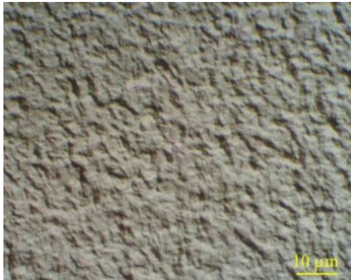
Rys. 5. Zdjęcie warstwy HgCdTe o orientacji (111) (mikroskop z kontrastem Nomarskiego).
