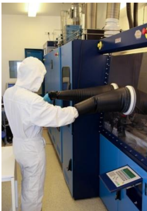
Rys. 2. Fragment linii MOCVD AIX 200 firmy Aixtron wykorzystywanej w projekcie.
